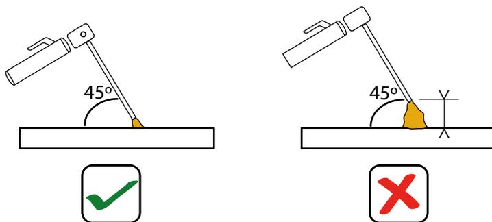
La distancia correcta entre el electrodo y el material base estará determinada por el diámetro del electrodo utilizado siendo :
