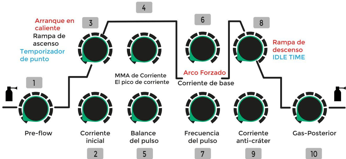
**1- Pre gas:** La función de pre gas permite establecer un flujo de gas previo a iniciar el arco eléctrico, para generar una limpieza de la zona a soldar y establecer una atmósfera de protección segura. El valor se expresa en segundos y se visualizará en el display.
