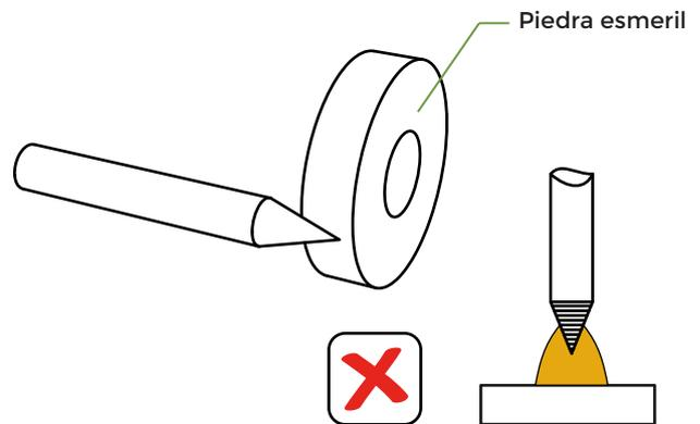
Si el afilado se realiza en sentido perpendicular a la piedra, se genera un rayado que da como resultado un arco más amplio e inestable.
