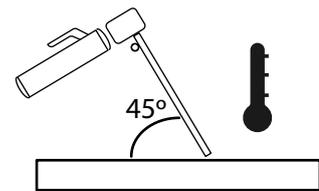
Al iniciar el cordón de soldadura, el metal base se encuentra frío. Es necesario una vez iniciado el arco, permanecer unos segundos en esa zona para generar el baño de fusión que luego se desplaza a lo largo de la unión.
