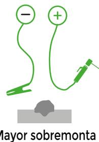
La conexión en polaridad inversa se produce conectando el cable de pinza (con pinza porta electrodo) al polo positivo (+) de la fuente de soldadura y el cable de masa (con pinza de masa) al polo negativo (-) de la fuente. El calor del arco eléctrico se concentra sobretudo en el extremo del electrodo, logrando mayor capacidad de aporte. Cada tipo de electrodo necesita un tipo específico de curso de corriente (CA o CC) y en el caso de corriente CC una polaridad específica.
