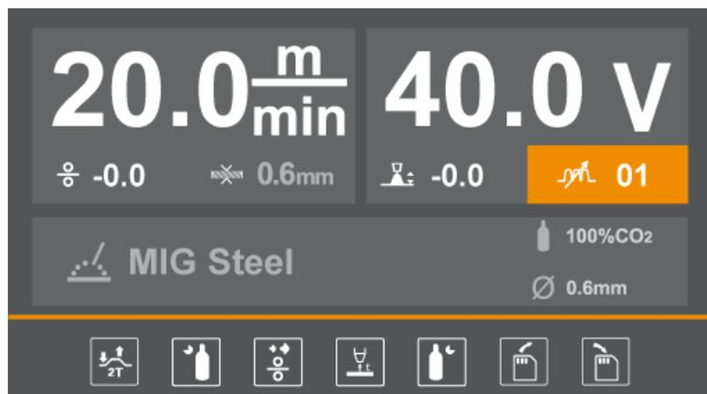
**Configuración de parámetros básicos que incluyen:** Pre gas (segundos), Velocidad del alambre (m/min), Post gas (seg.), Stick out (mm), Almacenamiento y carga de configuraciones.
