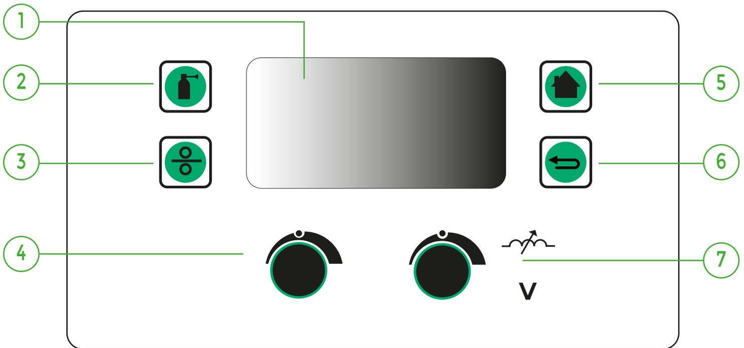
**1-LCD:** Permite visualizar de manera intuitiva todos los parámetros de soldadura a configurar.
