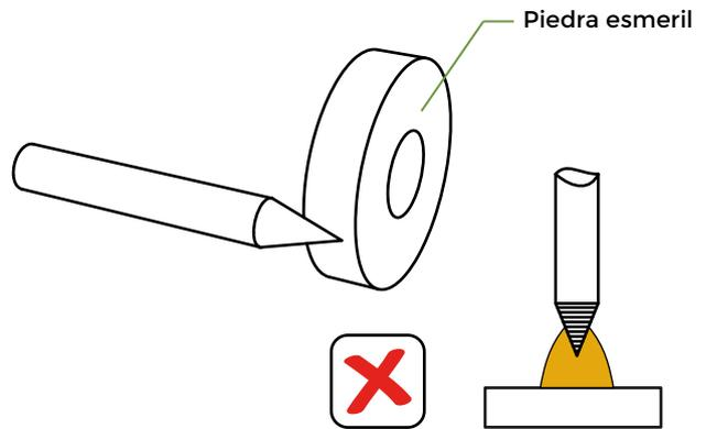
El afilado deberá hacerse siempre en el sentido de giro de la piedra de afilado. Esto ayuda a direccionar el arco hacia el extremo del electrodo.
