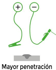
La conexión en polaridad directa se produce conectando el cable de pinza (con pinza porta electrodo) al polo negativo (-) de la fuente de soldadura y el cable de masa (con pinza de masa) al polo positivo (+) de la fuente. El arco eléctrico concentra el calor producido en la pieza favoreciendo la fusión y penetración en la misma.
