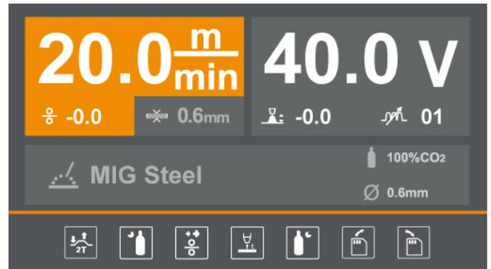
Regule de velocidad de alambre expresada en Metros/ Minuto y Amperaje. Este control configura de manera simultanea ambos parámetros y determina la cantidad de material aportado en unidad de tiempo.
