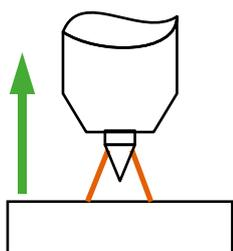
3 - separación y generación de salto de chispa, aumento de la corriente hasta el valor configurado de soldadura.
