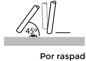
La soldadura MMA se refiere a soldadura con electrodos revestidos. El arco eléctrico funde el electrodo y el revestimiento forma una capa de protección (escoria). Si para abrir el arco, el electrodo se presiona contra la pieza a ser soldada, el electrodo se funde y adhiere en la pieza haciendo imposible la soldadura. Existen dos formas de encender el arco correctamente, por golpeo o por raspado siendo esta última la más utilizada.
