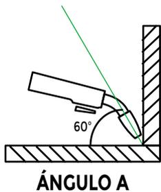
El ángulo A se puede variar. En la mayoría de los casos, el ángulo óptimo es de 60 grados, punto en el que el mango de la torcha está paralelo a la pieza a trabajar. Al aumentar el ángulo A se aumenta la penetración. Al disminuirlo, se disminuye la penetración.
