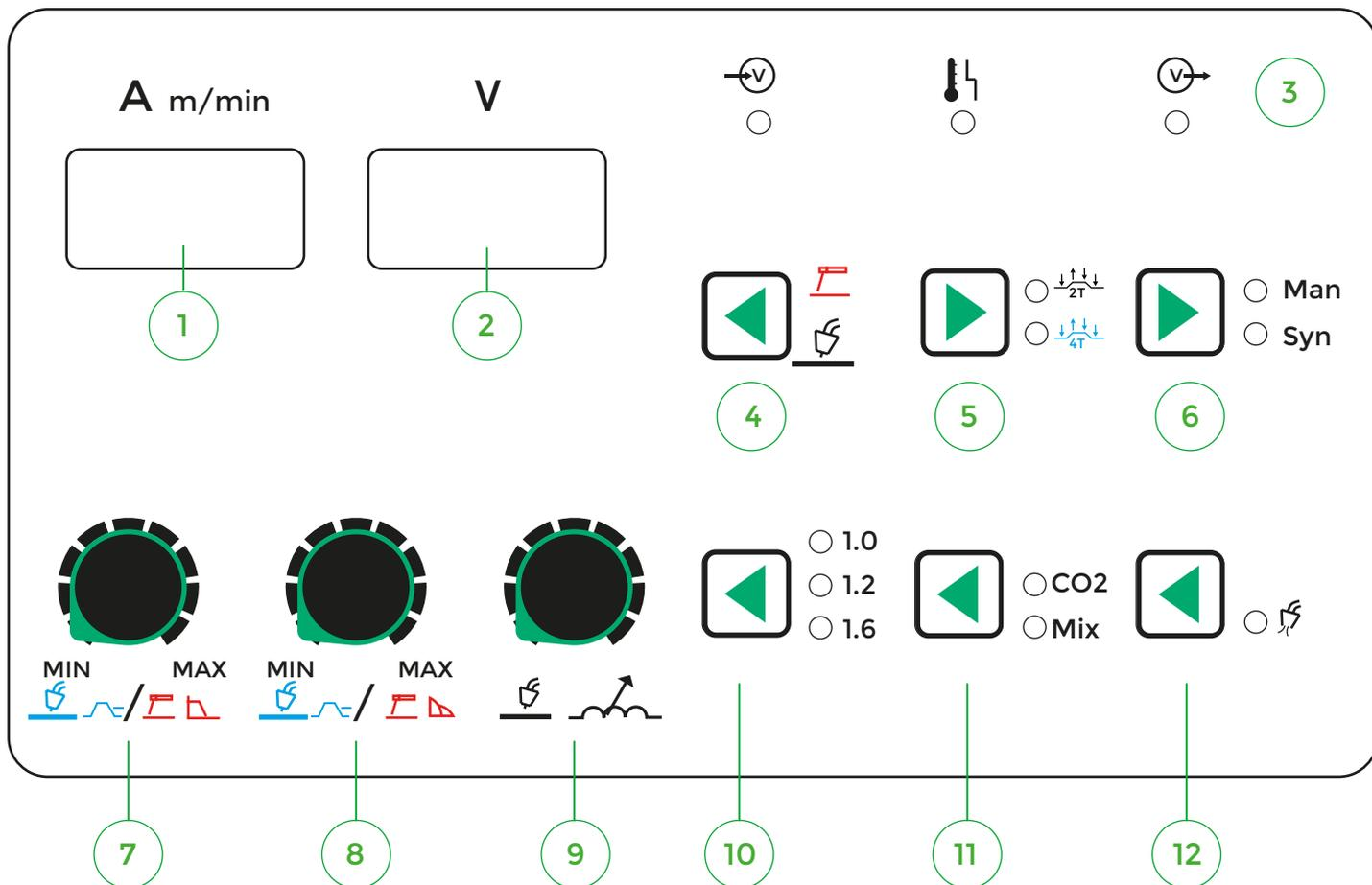
**1 - Monitor de corriente:** Funciona en los dos procesos de soldadura MIG y MMA. La corriente de soldadura se verá expresada en Amperes.
