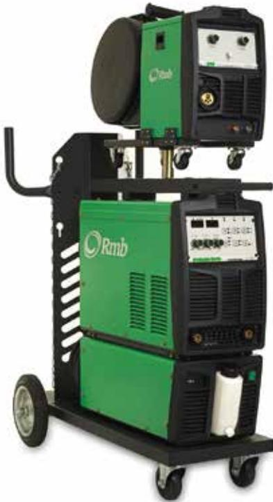
Es la elección más inteligente en soldadura de más de 350 a 500A. Cuenta con cabezal independiente para trabajos de gran porte, un sistema sinérgico de configuración simple, y un robusto motor de doble arrastre que se complementa con el cabezal.
