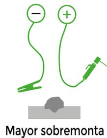
La conexión en polaridad inversa se produce conectando el cable de pinza (con pinza porta electrodo) al polo positivo (+) de la fuente de soldadura y el cable de masa (con pinza de masa) al polo negativo (-) de la fuente. El calor del arco eléctrico se concentra sobretodo en el extremo del electrodo, logrando mayor capacidad de aporte. Cada tipo de electrodo necesita un tipo específico de curso de corriente (CA o CC) y en el caso de corriente CC una polaridad específica.
